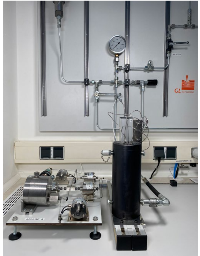
Abb. 2 Einbauplatz, Probenhalter mit Fluidports, Medientrenner und pneumatisch betätigtes Ventilarray
