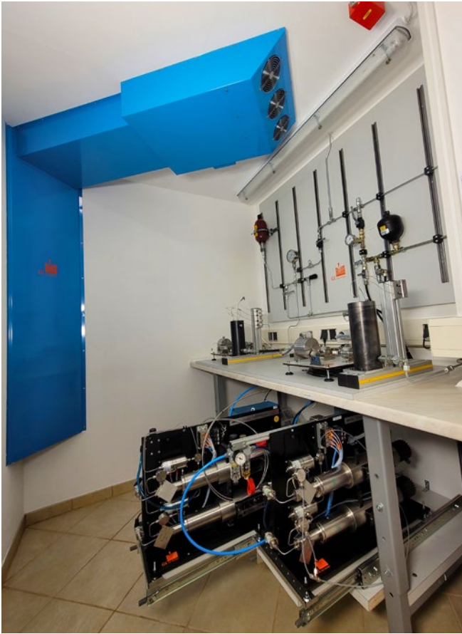
Abb. 1 Temperaturerhalteter Messraum mit geregelter Umluftheizung, zwei Einbauplätze mit Umschließungsdruckstabilisierung und Präzisionspumpen
